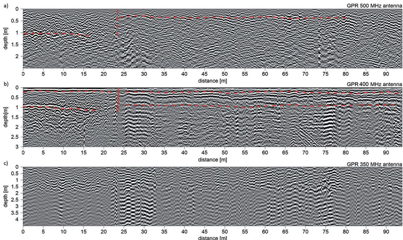
Fig. 6. Radargram: a) antenna 500 MHz, b) antenna 400 MHz, c) antenna 350 MHz.
