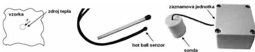
Obr. 2. Model metódy horúcej guľôčky (vľavo); senzor horúcej guľôčky (v strede); teliesko sondy a záznamová jednotka (vpravo) (upravené podľa Kubičára et al., 2006). Fig. 2. Model of the hot ball method (left); hot ball sensor (in the middle); data logger in connection with the hot ball probe (right) (according to Kubičár et al., 2006).
